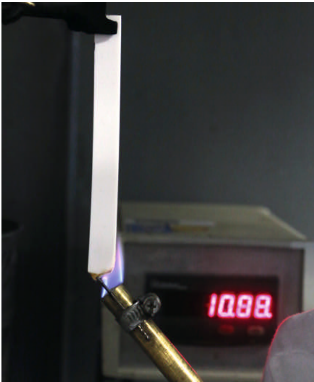
Bild 1. Die Einstufung der Brandklassen von Kunststoffen erfolgt nach dem Standard UL94 der Underwriters Laboratories (vertikale Brandprüfung)
