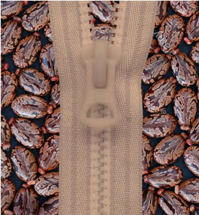
Aus solchen Rizinussamen entsteht der biobasierte Kunststoff VESTAMID® Terra für Reißverschluss und Gewebband.
