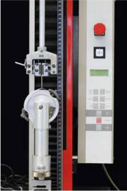
**Bild 1.** Aufbau einer Rollenschälprüfung, um die Schichtenhaftung eines mehrschichtigen Kunststoffrohrs mit einer Zugprüfmaschine zu ermitteln (© Evonik)
