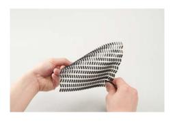
Die Sohle R-COMPO® von Daicel-Evonik enthält Gumminoppen für eine gute Griffigkeit in einem stoffschlüssigen Verbund mit der Polyamid 12-Sohle.
