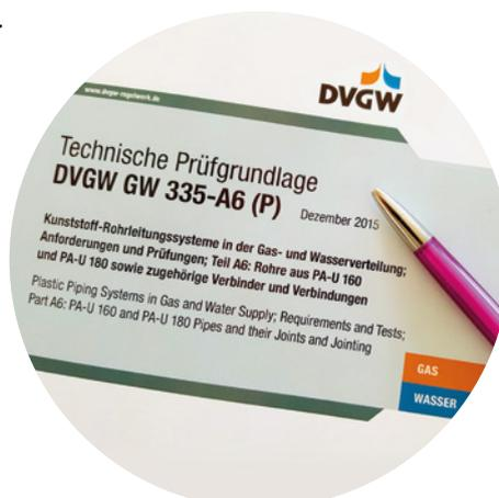
Von Kunststoffrohren im Gasbereich wird eine Mindestlebensdauer von 50 Jahren bei 20°C und bei maximalem Betriebsdruck gefordert. Dieser maximale Betriebsdruck wird durch Zeitstand Innendruckprüfungen nach ISO 9080 ermittelt.
